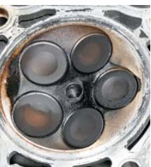
YAMAHA 5V. Più grandi qui le valvole di scarico; da notare il disallineamento di quella centrale di aspirazione. Nell'altra pagina: la testa 4V della YZ450F.
