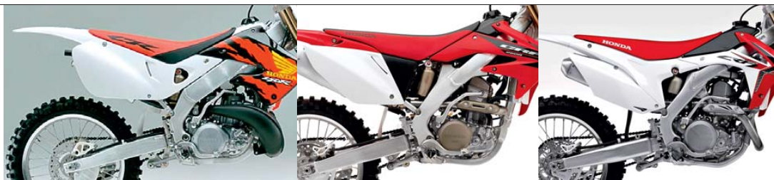
HONDA DALL'ORIGINE FINO A OGGI. La prima esecuzione del telaio CR 250 già a schema perimetrale, poi il primo duemmezzo 4T 2005, infine la CRF 450 2013. L'affinamento tecnologico ha portato a dimensionamenti di telaio decisamente ridotti.
