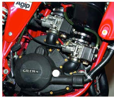
**Nel riquadro: il motore del B 125 e, in questa foto, il monocilindrico raffreddato a liquido nato a sua volta nel 1980.**
