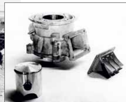
Cilindro con canna trattata al nickel-silicio, pistone e lamelle del motore 1981, accreditato di 29 CV a 11.000 giri e coppia di 1,9 kgm a 10.000 giri. Arco di utilizzo: fra i 7.500 e gli 11.000 giri.
