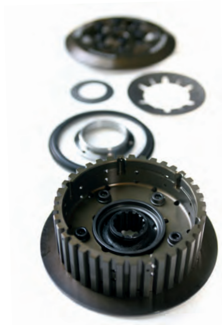
Il sistema Suter impiega il pacco dischi originali di tutte le cross 4T.
