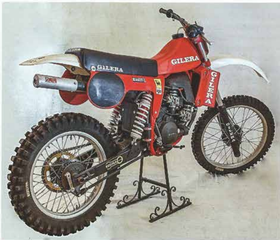
Der Gilera 125 C2-Crosser brachte es mit seinem Zweizylindermotor auf brisante 44 PS Spitzenleistung. Doch dann erlaubte das Reglement nur noch Motoren mit einem Zylinder
